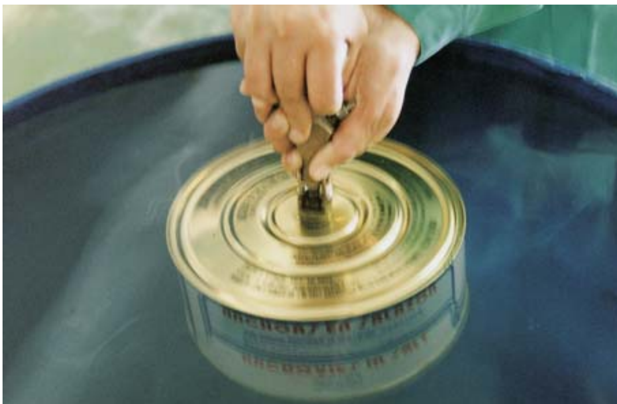
Comprobación de estanqueidad de cierres.
