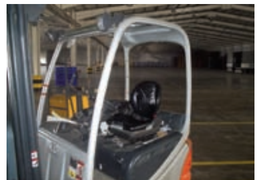
Detalle del pórtico de seguridad.
